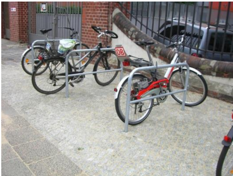
Bild 3-1: Rahmenhalter mit Doppelholm
